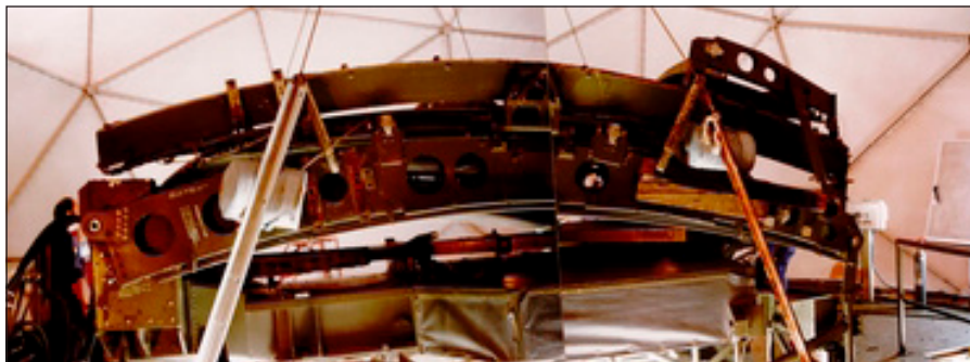
La antena ya colocada en el radomo pero aún plegada
